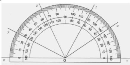
Le centre du rapporteur se place sur le sommet de l'angle et on superpose un côté de l'angle avec la "ligne" correspondant à 0°.
