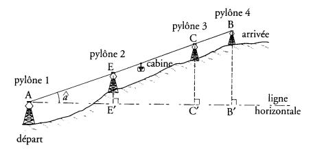
Entre A et B, on considere que le caple est rectiligne. Il mesure 2,48 km. Il est soutenu par 4 pylônes. Laltitude au point A est 2 100 m. Au point B elle est de 2 620 m.
