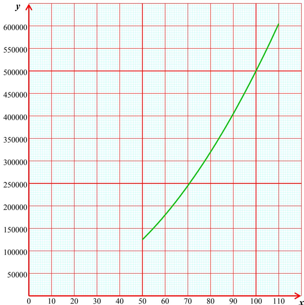
3- **Déterminer**, en utilisant la représentation graphique précédente, l'énergie cinétique  $E_c$  du véhicule à 100km/h. **Laisser** apparents les traits utiles à la lecture.
