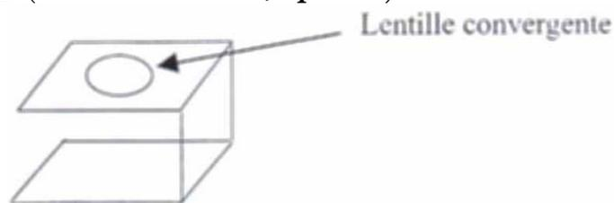
Le compte fils schématisé ci-dessus est un objet utilisé en imprimerie. Il permet la visualisation de la trame d'un document en grossissant celui-ci. Il est constitué d'une lentille simple convergente.
